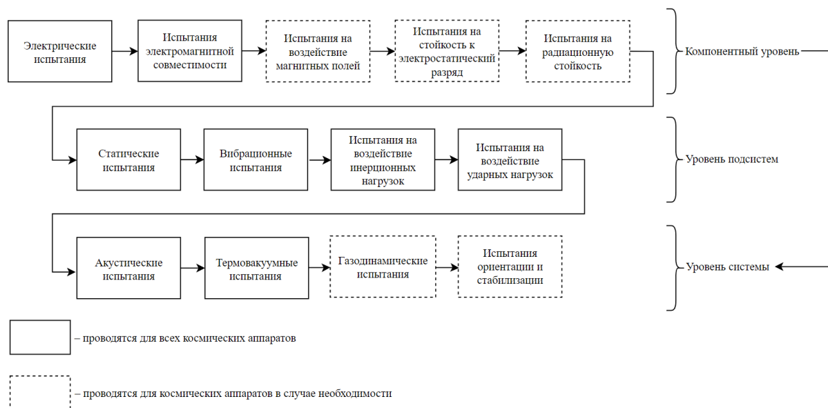
Рис. 1. Обобщённая схема последовательности испытаний космических аппаратов
